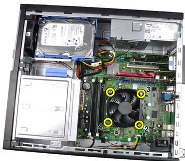
5. Levante o conjunto do dissipador de calor e retire-o do computador. Coloque o conjunto com a ventoinha voltada para baixo e com a massa térmica para cima.
