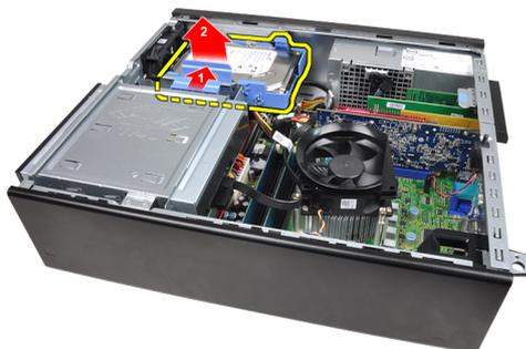
5. Flicta o suporte da unidade de disco rígido e depois retire a unidade de disco rígido de 3,5 polegadas ou as duas unidades de disco rígido de 2,5 polegadas do suporte.
