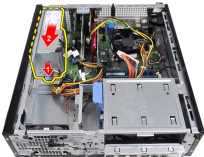
10. Levante a fonte de alimentação e retire-a do computador.
