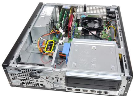
5. Retire o parafuso que fixa o painel de entrada/saída ao chassis.
