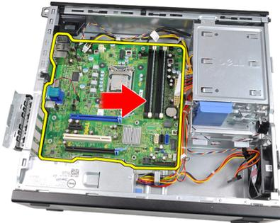
**11.** Retire a placa de sistema do chassis.
