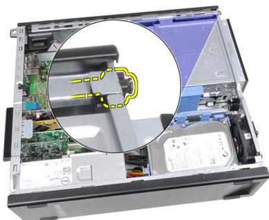
6. Deslize o cabo do interruptor de alimentação para fora através da parte frontal do computador.
