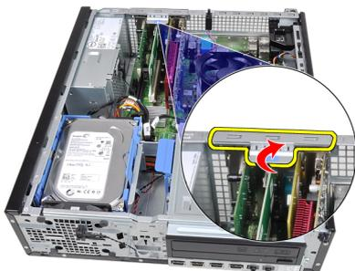
4. Afaste a alavanca de desbloqueio da placa PCIe x16 até soltar a patilha de fixação do entalhe na placa. Em seguida, liberte a placa do respectivo conector e retire-a do computador.
