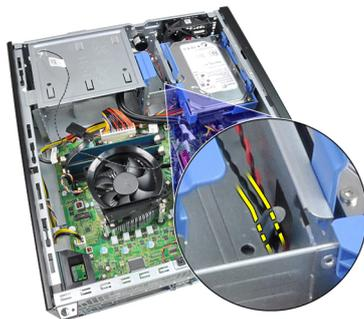
7. Levante e retire o sensor térmico da parte anterior do chassis.
