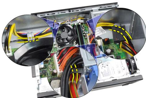
6. Retire o cabo do sensor térmico do grampo no chassis.
