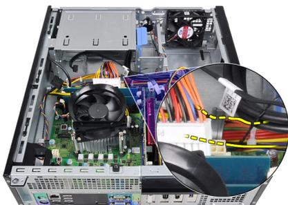
8. Retire os parafusos que fixam a fonte de alimentação à parte posterior do computador.
