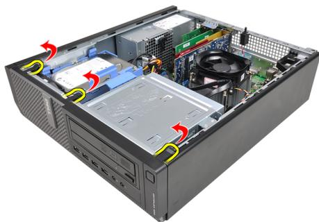
4. Rode e retire a moldura do computador para soltar do chassis os ganchos existentes na extremidade oposta da moldura.
