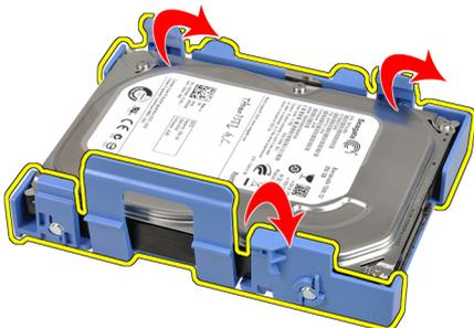
6. Vire ao contrário o suporte da unidade de disco rígido e retire os parafusos que fixam unidade de disco rígido de 2,5 polegadas à parte inferior do suporte.
