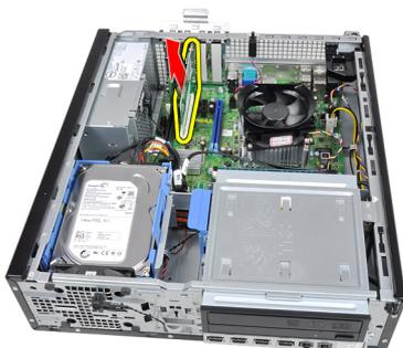
7. Levante a placa de expansão PCI x4 (se existir) para fora do respectivo conector e retire-a do computador.
