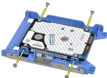
8. Retire os parafusos que fixam a unidade de disco rígido de 2,5 polegadas à parte superior do suporte da unidade de disco rígido.
