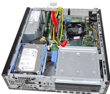
5. Levante a placa de expansão PCIe x1 (se existir) para fora do respectivo conector e retire-a do computador.
