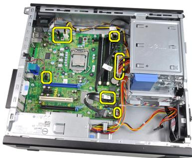
8. Levante e solte o trinco da placa de expansão para aceder aos parafusos que fixam a placa de sistema.
