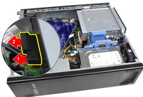
5. Deslize para cima o trinco da unidade óptica e depois empurre a unidade da parte posterior para a parte anterior do computador.
