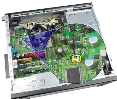
5. Retire o cabo do sensor térmico dos grampos no chassis.
