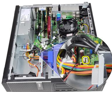
4. Retire o cabo do sensor térmico do grampo no chassi.
