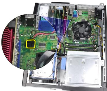
4. Deslize o interruptor de intrusão na direcção da parte inferior do chassis e depois retire-o da placa de sistema.
