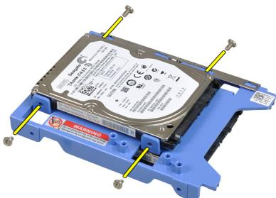
7. Flicta o suporte da unidade de disco rígido e depois retire as duas unidades de disco rígido de 2,5 polegadas do suporte.
