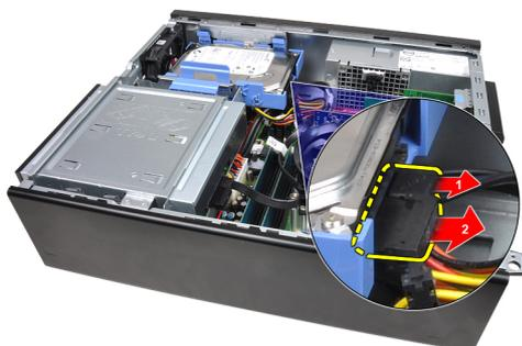
4. Prima para a frente o trinco do suporte da unidade de disco rígido em direcção à unidade e levante-o.
