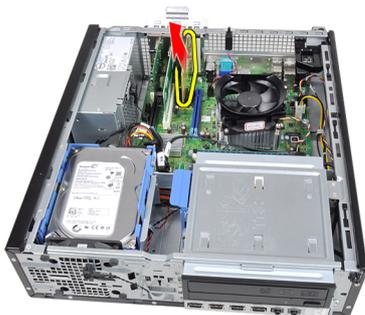
6. Levante a placa de expansão PCI (se existir) para fora do respectivo conector e retire-a do computador.
