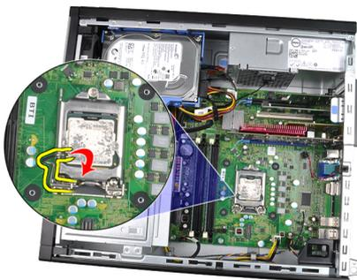
8. Levante o processador para o retirar do encaixe e coloque-o numa embalagem antiestática.
